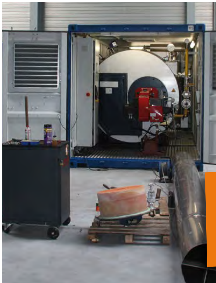
Préparation d'une chaudière 3t/h avant expédition sur le site du client
